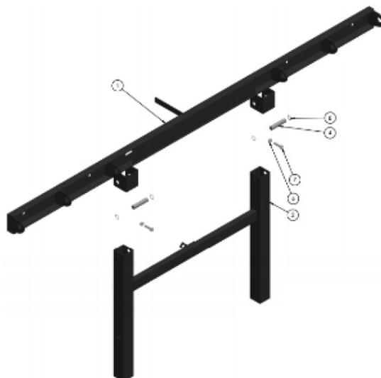
Em seguida, posicione os pistões pneumáticos conforme indicado no desenho acima. Instale as plataformas de acesso seguindo o modelo apresentado. Fixe as bases com os parafusos de ancoragem fornecidos pela fábrica. Passe a mangueira de ar por dentro da rampa e conecte-a aos pistões e à válvula. Nivele o equipamento utilizando uma mangueira de nível entre os oito pontos de nivelção da rampa.
